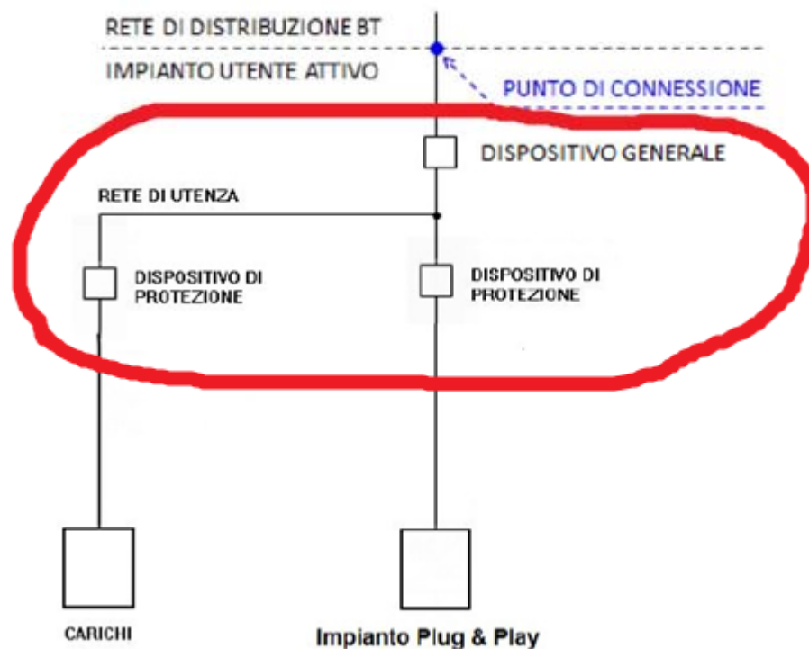
Figura 17 – Schema elettrico di massima per la connessione alla rete di un Impianto di produzione “Plug & Play”
